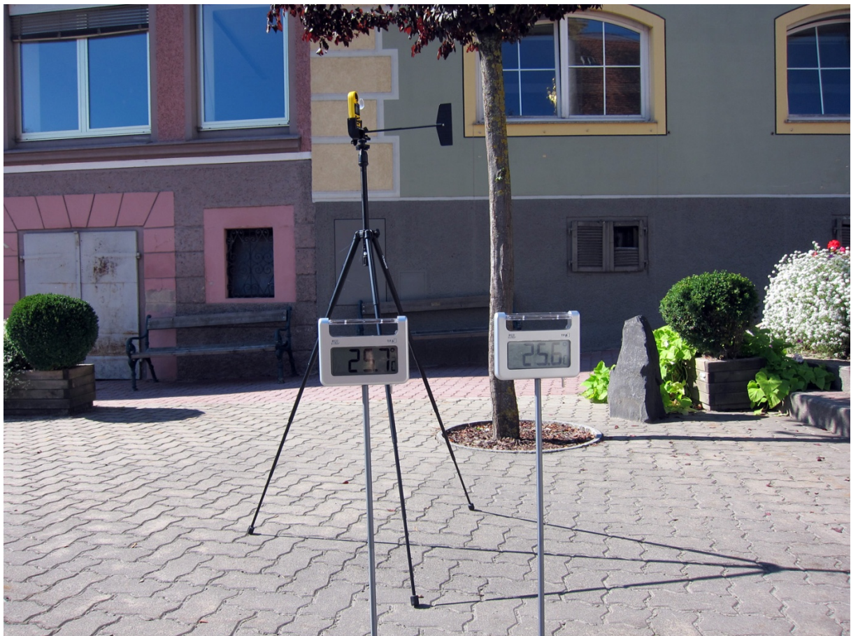
Abb. 1: Mikrowetterstation Kestrel (gelber Sensor am Stativ) und Gartenthermometer (mit Temperaturanzeige) am Hauptplatz von Pischelsdorf am 1. Oktober 2011 mittags.
